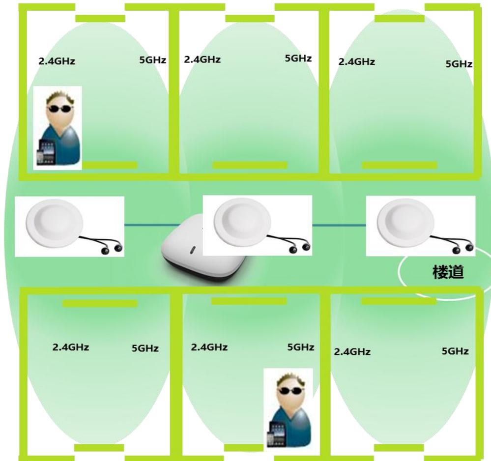
无线 AP 是无线网络的接入点，为最终用户提供无线终端接入，支持 802.11ac 技术，具备 2.4G 和 5G 双频技术，具备智能天线，支持频谱导航、频谱防护、逐包功率控制、智能负载均衡等特性。
